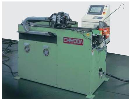
SP型パイプベンダー カラーCRT、カセットテープ又は フロッピーシートデータ記憶付の高速機種
